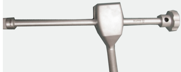
Maillet à frapper positionné sur la tige de retrait
